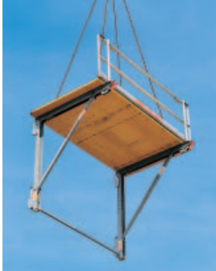
Liitä 4-haaraiset nostoraksit tasossa oleviin nostolenkkeihin.
