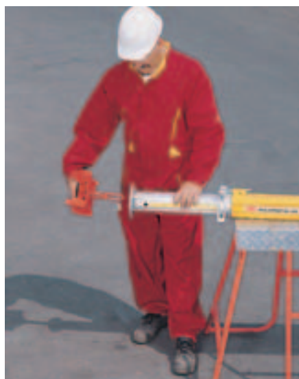
Tukihaarukka ja välituen haarukka kiinnityssalpoineen.
